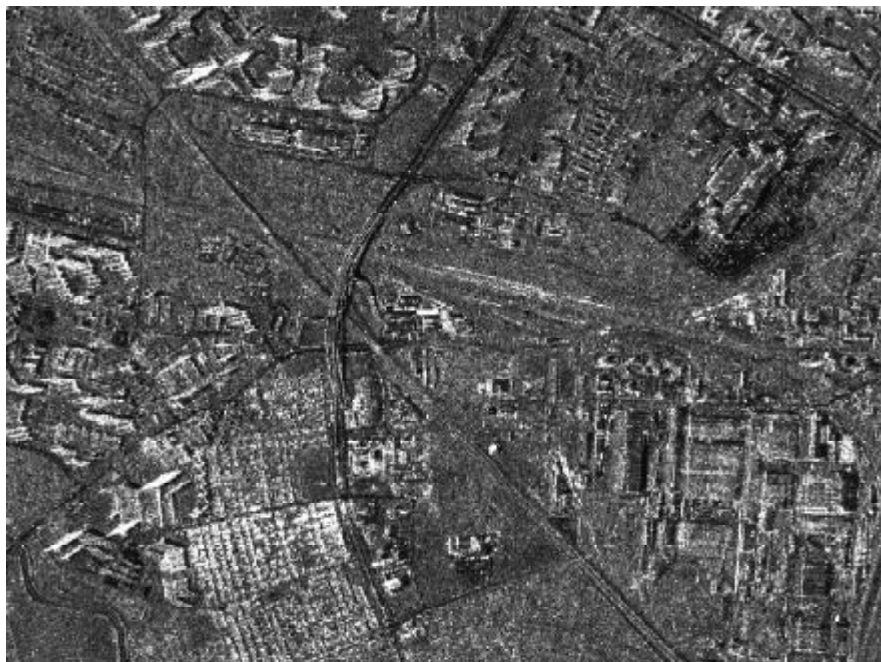
Rys. 7. Południowo-zachodnia część Wrocławia. Obraz w rozdzielczości 1,25 m w polaryzacji HH Źródło: GEOSYSTEMS Polska.
