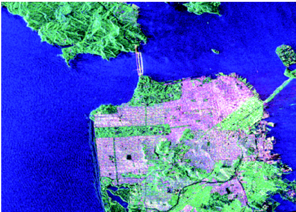
Rys. 9. Zobrazowanie z satelity RADARSAT-2 wykonane w poziomej polaryzacji i rozdzielczości 10 m; San Francisco, USA
